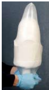
Bolsas de PVA en diferentes anchos para laminar con resina
